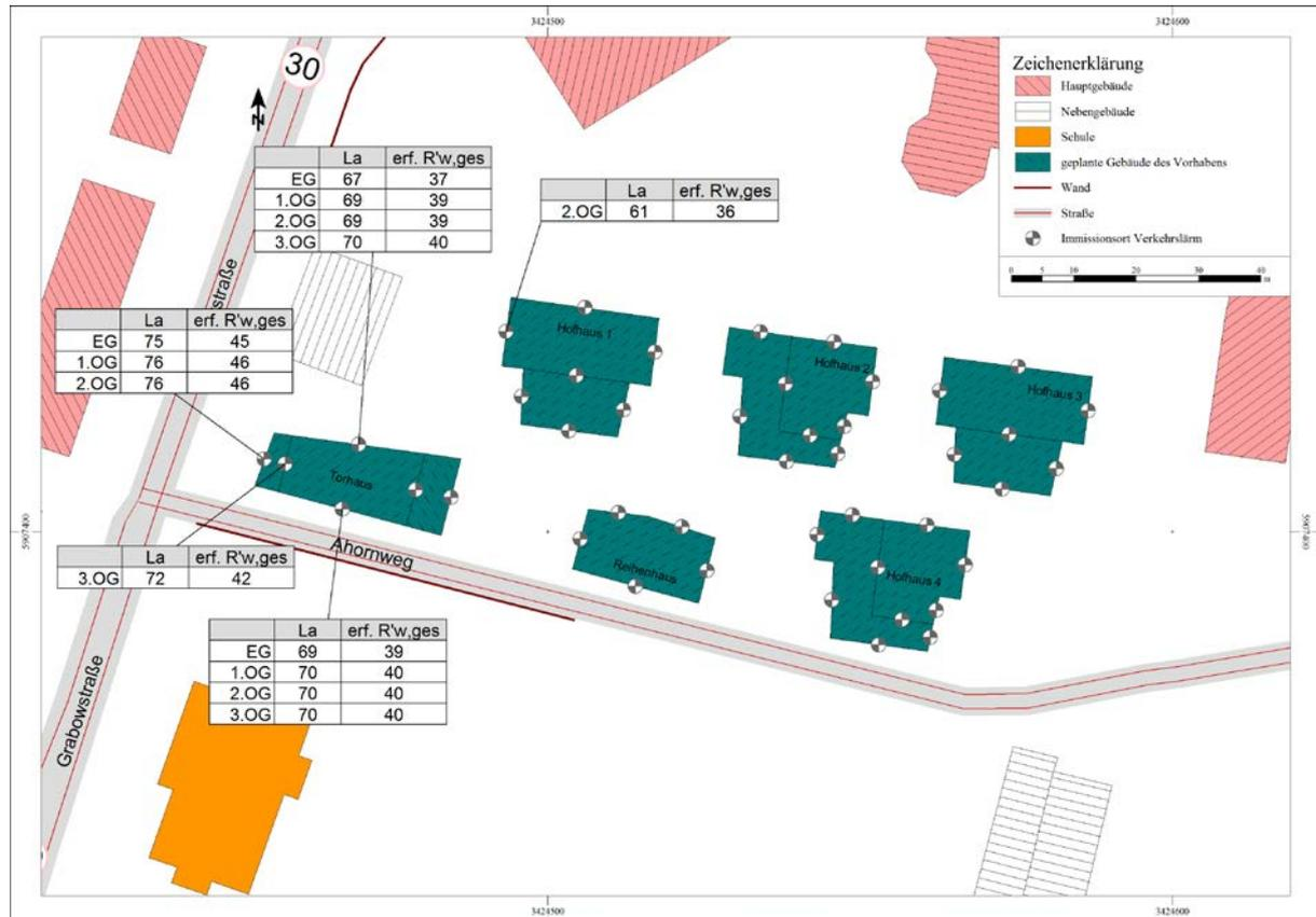
Abbildung 29: Maßgebliche Außenlärmpegel  $L_a$  und Anforderungen an das gesamte bewertete Bau-Schalldämm-Maß  $R'_{w,ges}$
